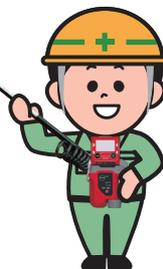
ポンプユニットと8m吸引チューブを使えば、入坑前に有害ガスの濃度が測定できます。
